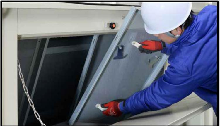
取外し可能なスクリーンを装備。工具不要でスクリーンの脱着が可能のため、乾燥部の掃除が容易にできます。
